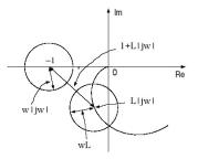
$|w_{\mathcal{P}}(1+L)^{-1}| + |w_{\mathcal{I}}L(1+L)^{-1}| < 1 \quad \forall \omega \quad \Leftrightarrow \quad |w_{\mathcal{P}}S| + |w_{\mathcal{I}}T| < 1 \quad \forall \omega$
